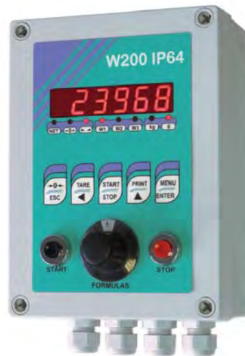
Versione in cassetta stagna IP64 in policarbonato: Dimensioni 180x130x77 mm. Quattro fori di fissaggio Ø 4 mm (interasse fori 163x113 mm); dotata di commutatore esterno per selezione formule (opzione EC), quattro pressacavi PG9, pulsanti di Start e Stop.
